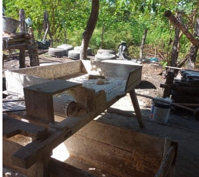
IMAGEM 6: Banco Caititu, ferramenta utilizada para transformar mandioca em maça para fazer farinha
